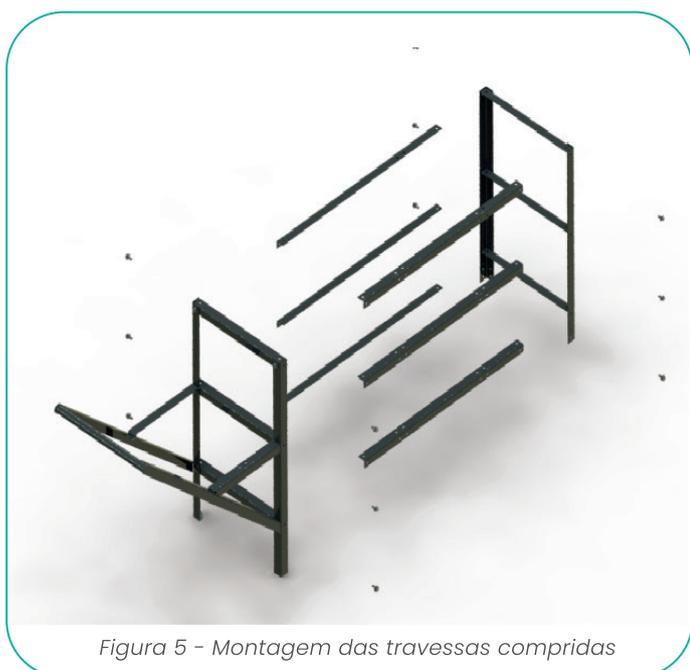
Figura 5 - Montagem das travessas compridas
