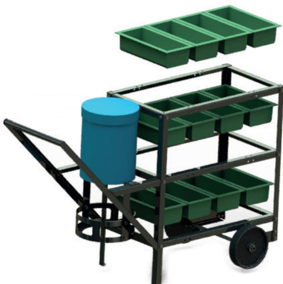
Figura 16 - Vista do posicionamento das bandejas e lixeira
