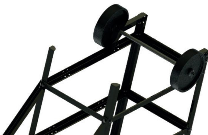
Figura 11 - Eixo com as rodas montadas
