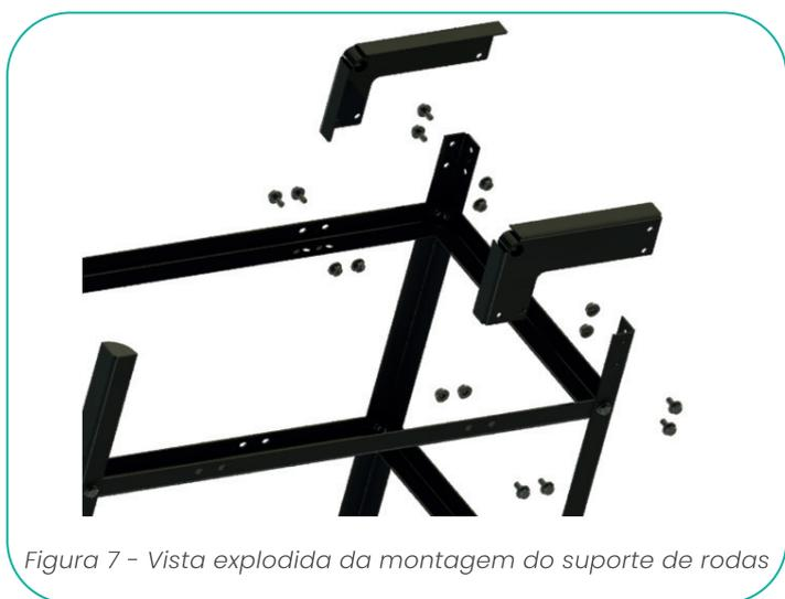
Figura 7 - Vista explodida da montagem do suporte de rodas
