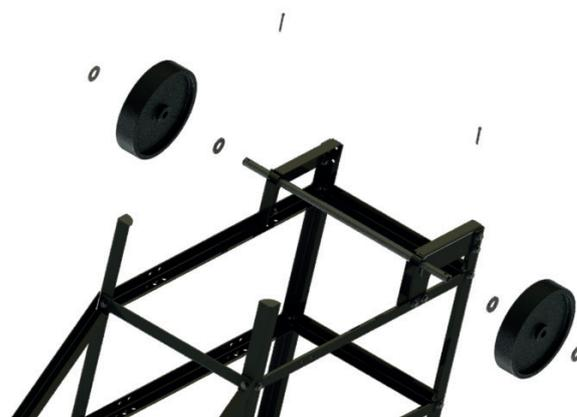
Figura 10 - Eixo instalado e vista da montagem das rodas
