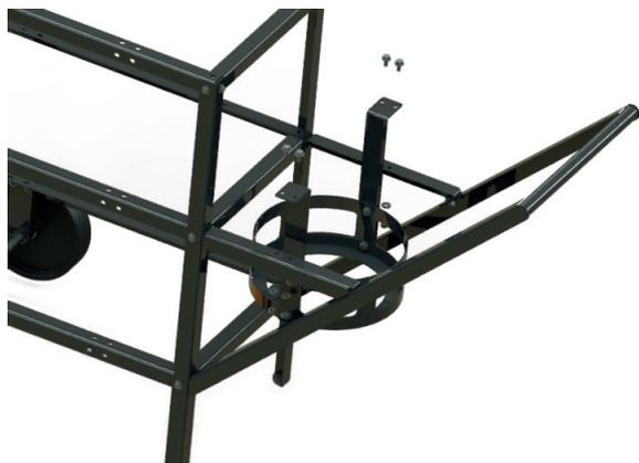
Figura 14 - Posição do suporte da lixeira na estrutura
